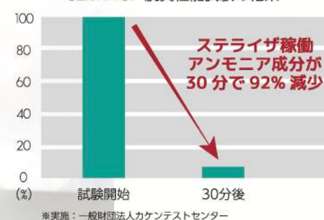
JEM1467 脱臭性能試験の結果
